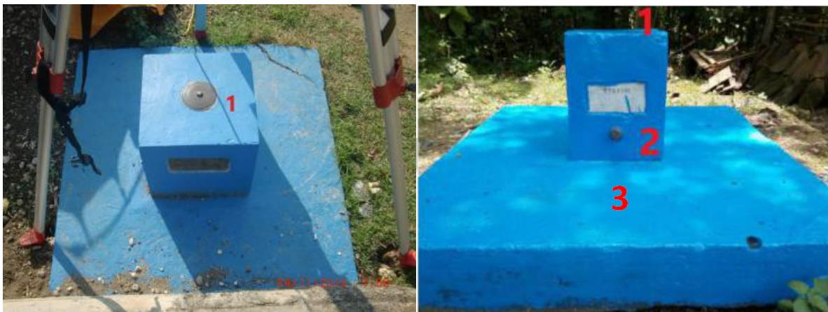
Gambar 2. Tanda kuningan acuan pengukuran 1) horizontal, 2) vertikal, dan 3) gayaberat
